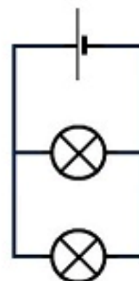
Circuito con una pila y dos bombillas en paralelo
